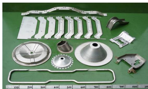
当社で設計製作した金型による製品例(パイプ&amp;板金)
