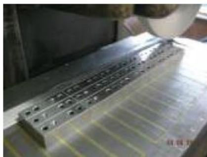
四角材への大径ネジ加工
