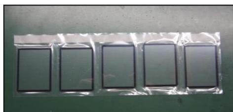
デジタルカメラ用パネルの検査においては、検査後に自社の独自技術により開発したラミネート機を使用することにより、パネルの両面をパックする工法を確立しております。これにより、出荷後のパネルの品質劣化を防ぐことを可能としております。
