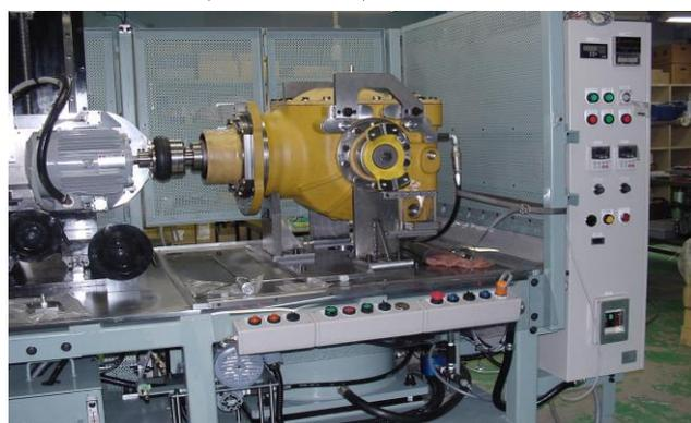
テーマ: 設備装置の多方向、多仕様品の取り付けが出来る試験装置
