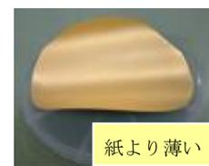
完成した超薄型ウエハ(30 μm)
