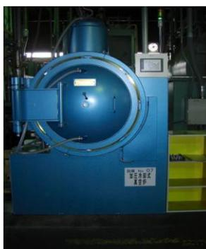
加圧冷却式真空炉
