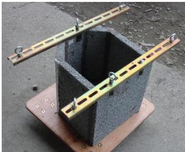
①自社開発の溶湯フィルターを使用し、溶湯中に含まれる酸化物を除去することにより、薄肉・高強度製品の生産が可能になりました。
