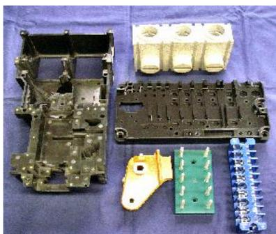
**大型熱硬化性樹脂インサート成形の例**
