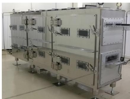
ロール搬送式真空加熱乾燥炉
