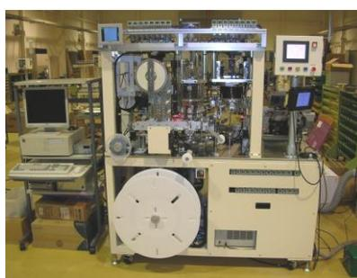
電子部品の電気検査をし、良品をテーピング収納します
