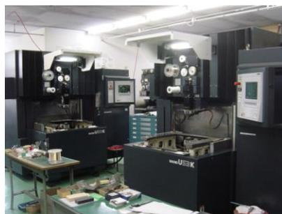
● 高精度水中ワイヤ放電加工機
